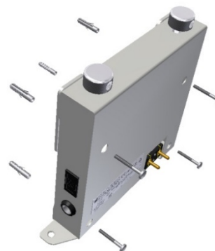
Figura 8: Instalação do suporte fixo
