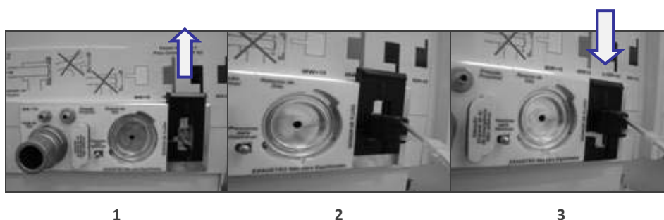
Figura 3-10 Montagem dos sensores de fluxo proximais
