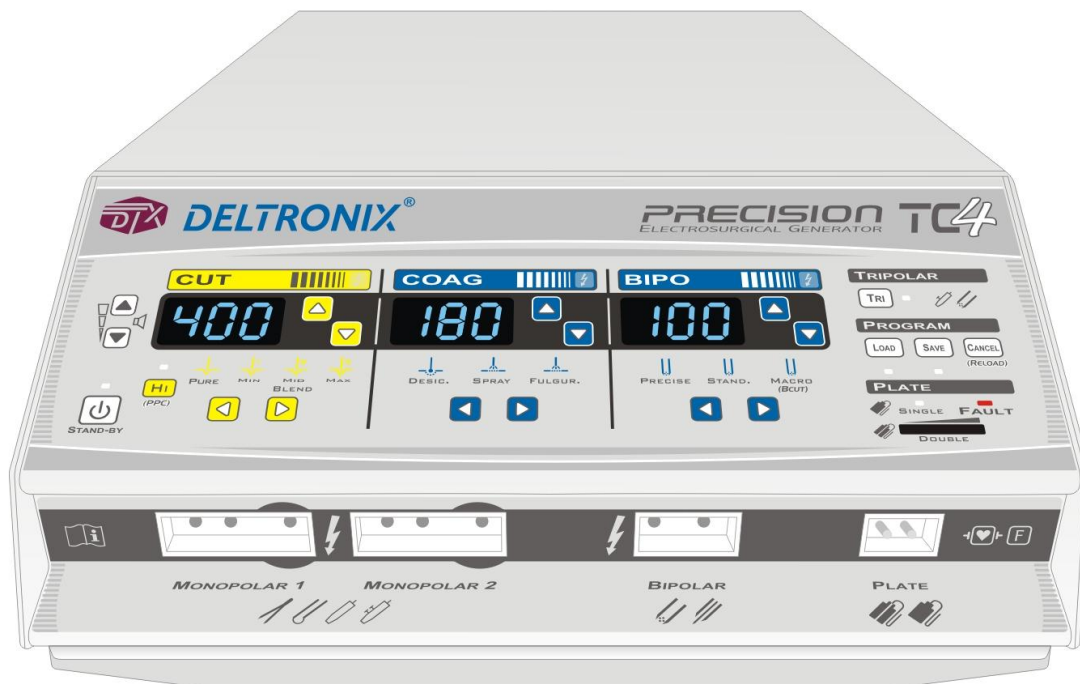
Figura 15. Bisturi Elétrico microprocessado, fornecendo até 400 Watts de potência no Corte Puro. Observe os controles para as funções de Corte, Blend, Coagulação e Bipolar. Todas as indicações são digitais. A tecla TRIPOLAR® está habilitada, além da indicação automática para placas simples ou duplas.
